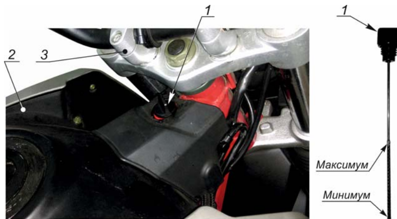
1 – щуп масляный; 2 – бак топливный; 3 – вилка передняя.
