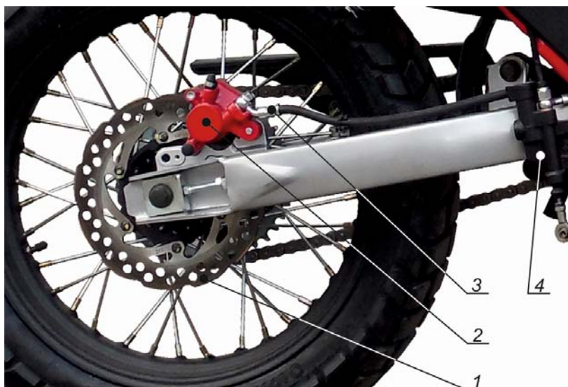
1 – диск тормоза; 2 – суппорт тормоза; 3 – шланг тормоза; 4 – главный тормозной цилиндр.
